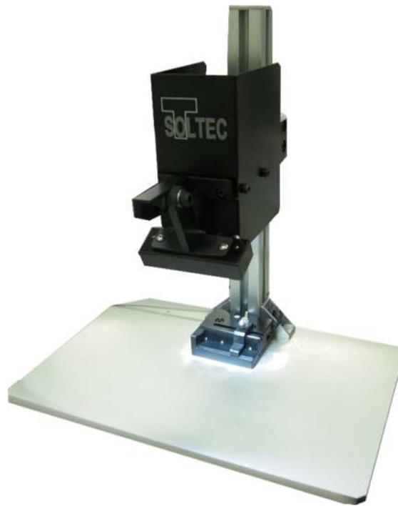
様々な検査項目を備えたソフトウェアを標準付属しています。コネクタに挿入された電線の色違いを始めとして、部品の形状違いや長さの違い、位置ずれの検査等を一つのソフトウェアで検査できます。
